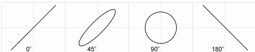
4.30 pav. Lissažu figūros, stebimos kai yra įvairūs signalų fazių skirtumai
