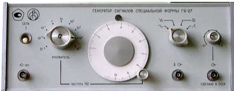
2.25 Analoginio funkcijų generatoriaus Г6–27 bendras vaizdas
