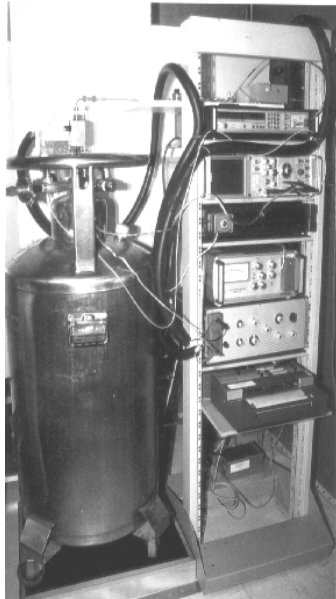
1.7. pav. Džozefsono keitiklio “dažnis – įtampa” schema (a) ir etalono bendras vaizdas (b)
