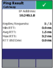
Рис. 5. Результат отправки запроса Ping на шлюз
